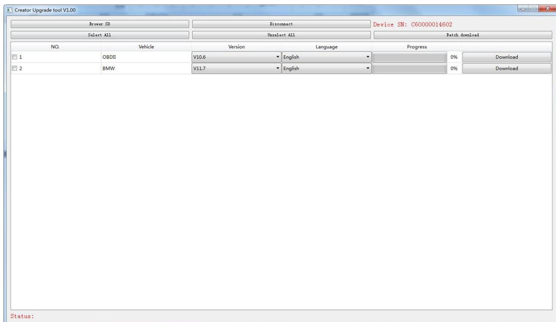
14. Cliquez sur le bouton [TÉLÉCHARGER] à la fin du logiciel du modèle à mettre à niveau, l'outil de mise à niveau téléchargera automatiquement le logiciel correspondant et l'enregistrera sur la carte SD
